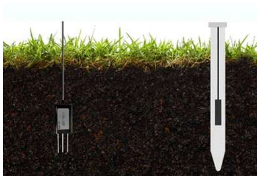
Fig 7: Sensorët për matjen e lagështisë së tokës
