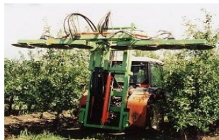
Figura 7. Sistemet për krasitje të montuara në traktor për një efikasitet të lartë
