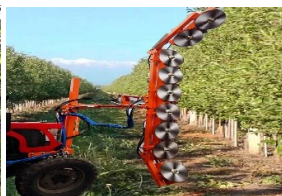
Figura 7. Sistemet për krasitje të montuara në traktor për një efikasitet të lartë
