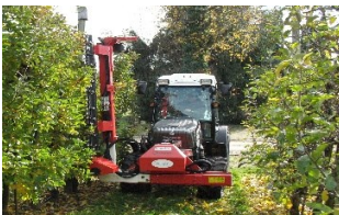
Figura 7. Sistemet për krasitje të montuara në traktor për një efikasitet të lartë
